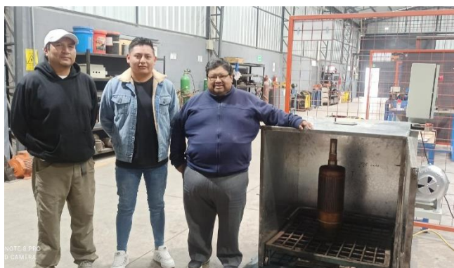
Figura. 13 Implementación del horno a gas para el secado de estatores en la empresa siproelectrik.
