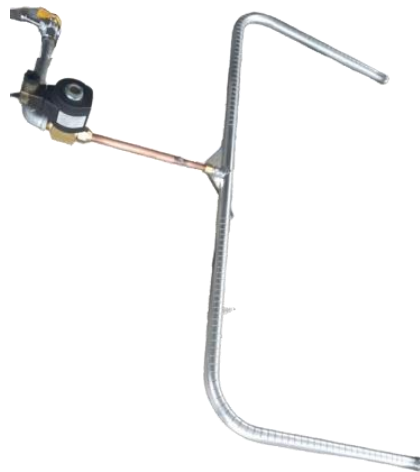
Figura. 8 Construcción y ensamble del quemador y la electroválvula de gas
