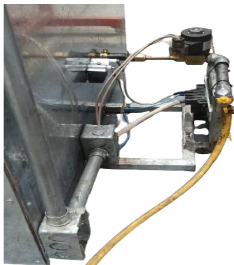
Figura. 10 Ensamble y conexiones de sensores, módulo de ignición, electroválvula al cuerpo del horno y al quemador.
