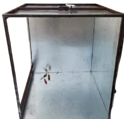
Figura. 2 Reconstrucción cámara interna del horno
