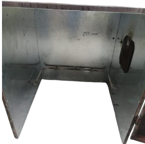
Figura. 9 Ensamble quemador al cuerpo del horno
