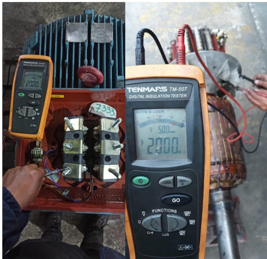
Figura. 15 Comprobación de la resistencia correcta
