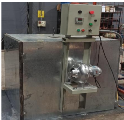
Figura. 12 Implementación del horno a gas para el secado de estatores en la empresa siproelectrik.
