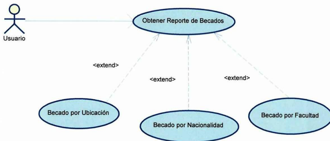
Fig. II.2.34.- Diagrama de Caso de Uso "Obtener Reportes de Becados"
