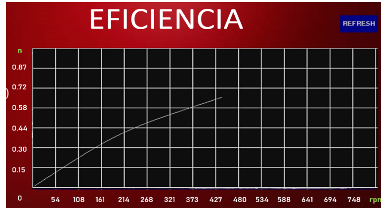
Figura 71 Eficiencia de la turbina Pelton a 55 metros y con un torque de 3,6 Nm
