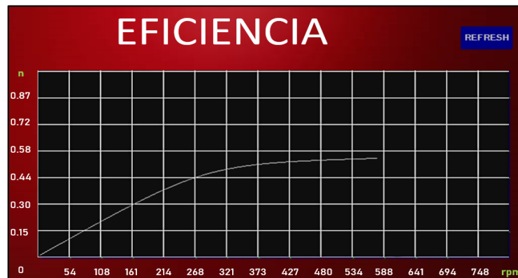
Figura 6149 Eficiencia de la turbina Pelton a 56 metros de altura y 2 Nm de torque
