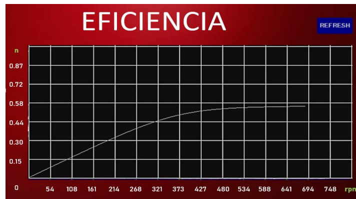
Figura 6750 Eficiencia de la turbina Pelton a 60 metros de altura y 2 Nm de torque
