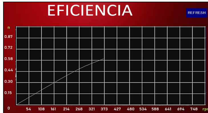
Figura 93 Eficiencia de la turbina Pelton a 56 metros y con un torque de 3,6 Nm
