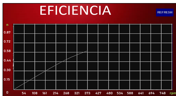
Figura 65 Eficiencia de la turbina Pelton a 56 metros y con un torque de 3,6 Nm
