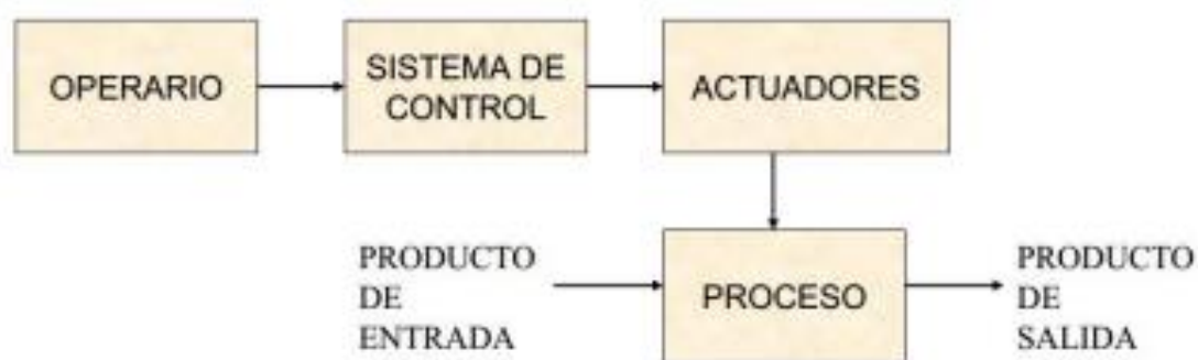
Figura 2. Diagrama Esquemático de un sistema de control de lazo abierto [5].
