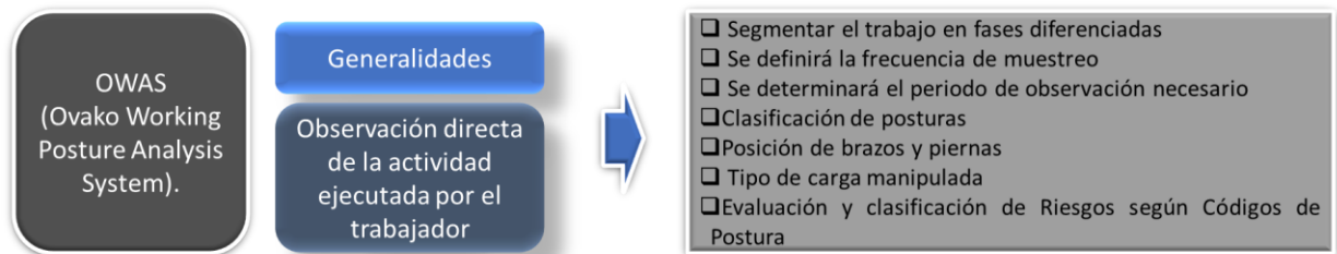
Figura 4-3. Síntesis de la aplicación del método OWAS
