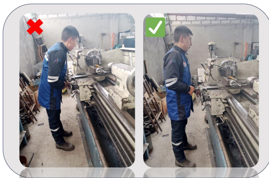
Figura 5-7. Postura incorrecta y correcta para las operaciones en las que se usa torno
