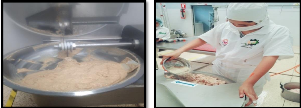
Fotografía 5: Cutteriado de insumos y carnes.
