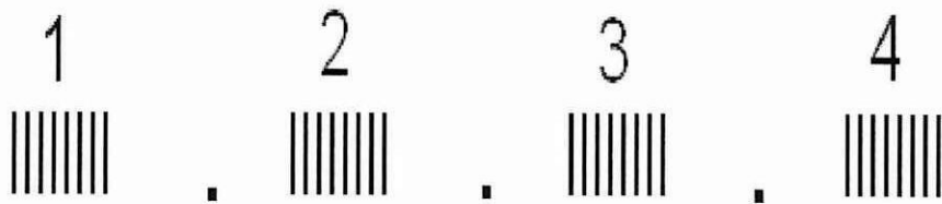
FIGURA 1.10 ESTRUCTURA DE 4 BYTES (32 BITS)
