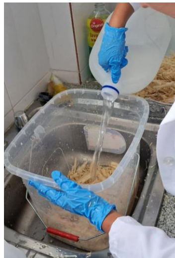
Ilustración 11. Lavado del bagazo de caña de azúcar utilizando agua destilada
