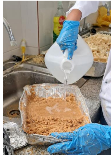
Ilustración 16. Lavado del aserrín utilizando agua destilada
