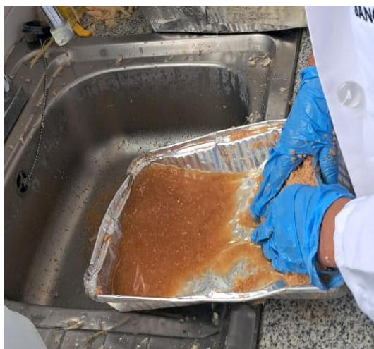
Ilustración 15. Lavado del aserrín utilizando agua potable
