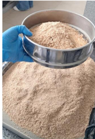
Ilustración 14. Tamizado inicial del aserrín
