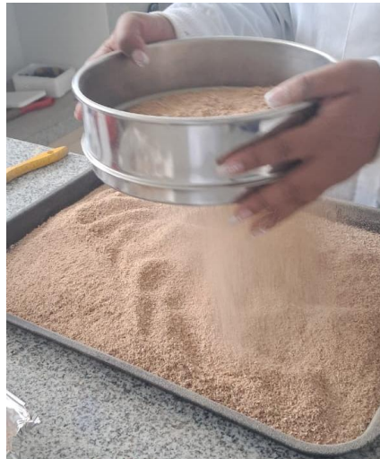
Ilustración 19. Tamizado final del aserrín
