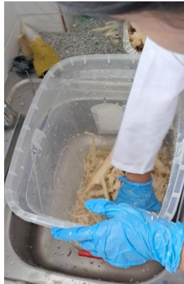
Ilustración 11. Lavado del bagazo de caña de azúcar utilizando agua destilada
