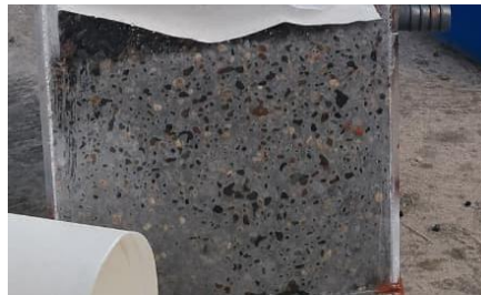
Ilustración 25. Capa de grava gruesa 10cm
