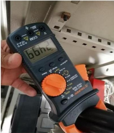
Medición del voltaje fase-fase y fase neutro
