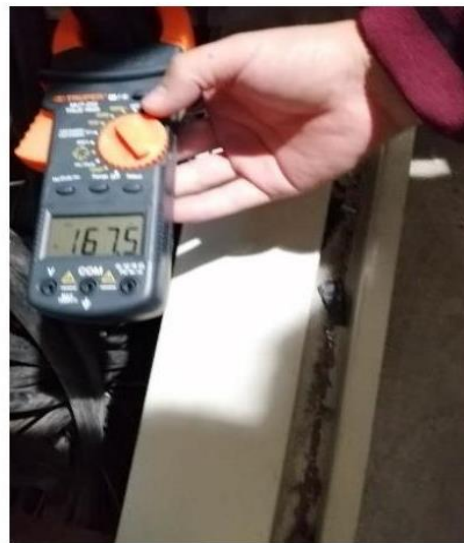
Medición del voltaje fase-fase y fase neutro
