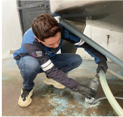
Figura 4-8. Toma de muestras del agua residual después del proceso de purificación
