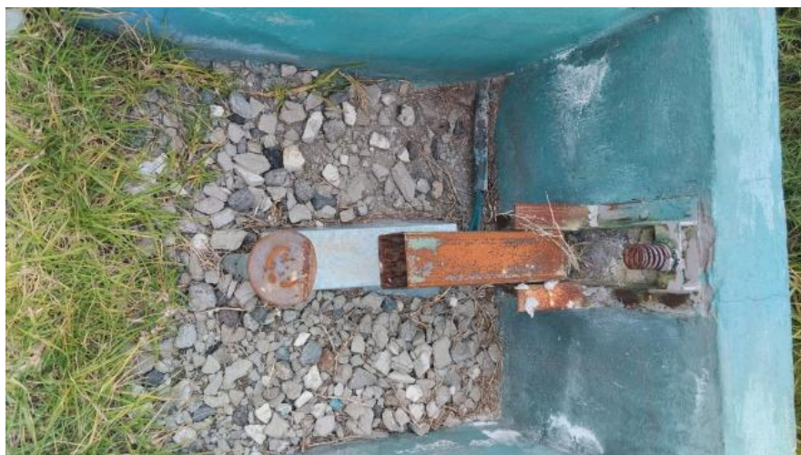
Acople para blanco abatible con el cilindro neumático
