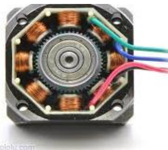
Figura 3.4. Motor paso a paso. Fuente: [22].
