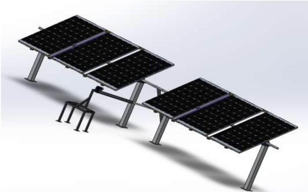
Figura 4.4. Diseño con 6 paneles solares de 1650x990x40mm.
