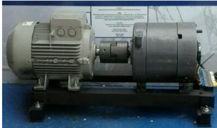
Figura 1.43 Grupo Motor - Generador
