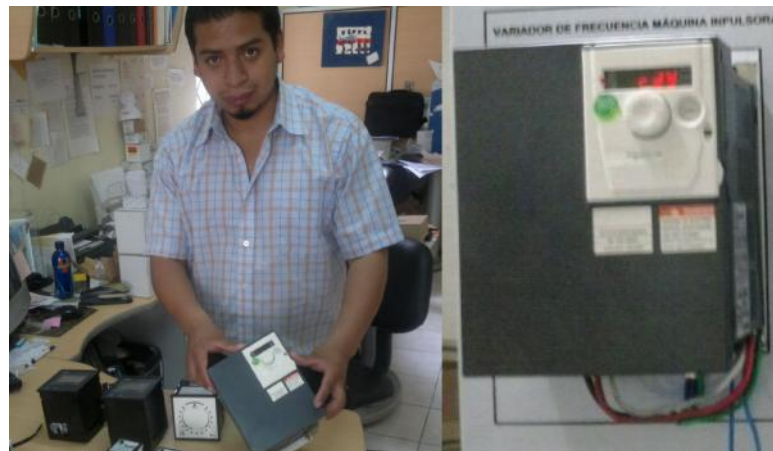
Figura 1.44 Variador de frecuencia
