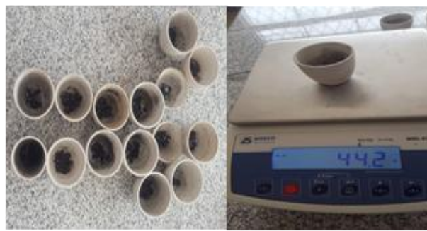
Fotografía 6.- Ceniza para efectuar el análisis se pesó con precisión (balanza analítica) en una cápsula previamente calcinada y tarada (m) 5 gramos de muestra homogeneizada (m1). Se puso en la mufla e incineró a 550 °C por 2 horas, hasta cenizas blancas o grisáceas. Se procedió al enfrió y las capsulas se colocaron en el desecador y posteriormente se ejecutó a pesarlas (m2).
