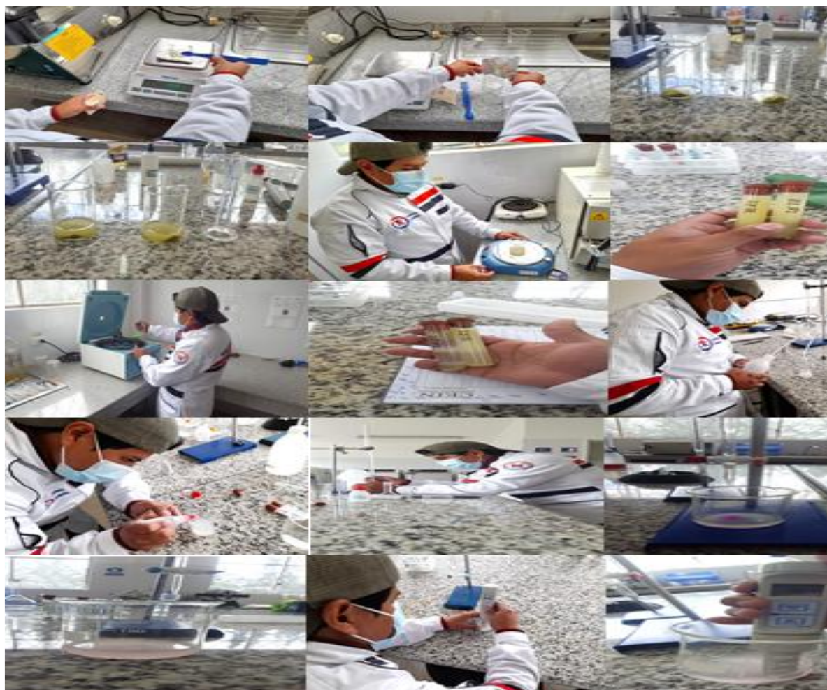
Fotografía 7.- Alcaloides se procedió a moler los chochos cosechados de diferentes índices de cada muestra y pesar 0,5 g de muestra en una balanza analítica y se colocó en un vaso de precipitación de 50 ml, después de ejecutó a colocar 20ml de agua, agitar 1 hora, colocar 10 min en la centrifuga, filtrar la solución, aforar y colocar en un vaso de precipitación. Después de haber realizado todos esos procesos, se colocó en la solución 2 gotas de fenoltaleína. Para obtener la extracción abrimos la bureta del Na (OH). Cuidadosamente ya que se
