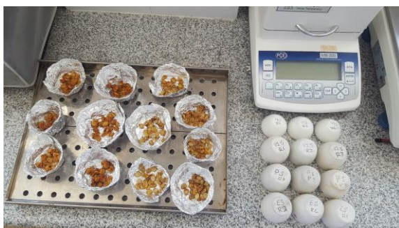
Fotografía 5.- Humedad consiste en someter la muestra a un proceso de secado mediante calentamiento a una temperatura suficiente para perder el agua por evaporación hasta peso constante. La diferencia de masas antes y luego después del secado que permite la estimación del contenido de agua en la muestra.
