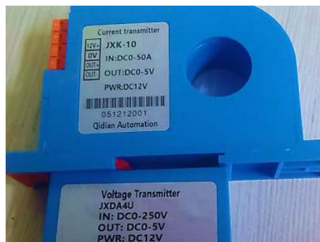
Figura 4.5: Especificaciones técnicas de los transmisores de voltaje y corriente.
