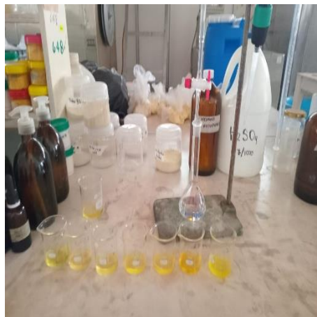
Figura N° 18. Titulación con NaOH al 0.01 N
