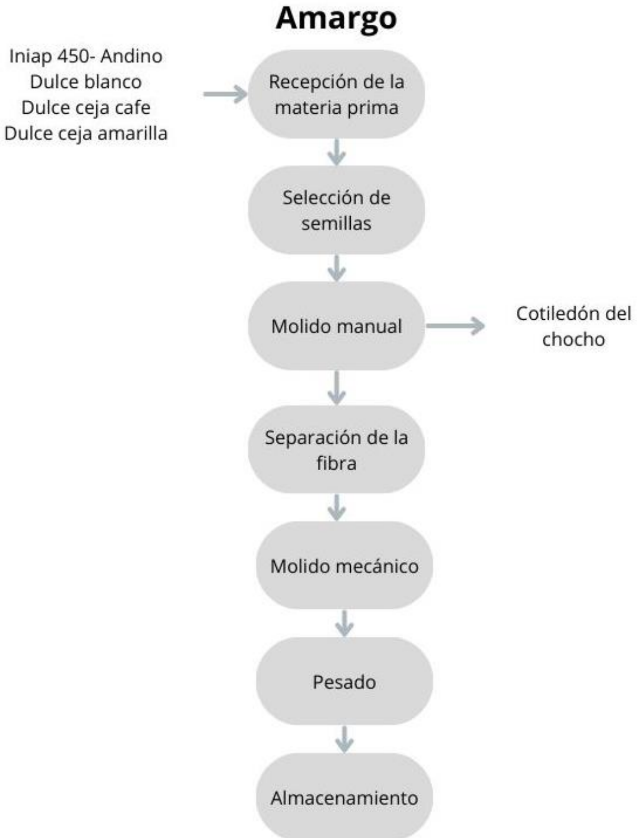
Figura N° 5. Diagrama de flujo del método de extracción de fibra- Amargo
