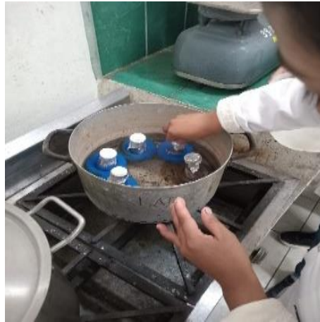
Figura N° 16. Ebullición de muestras para determinar FDI y FDS
