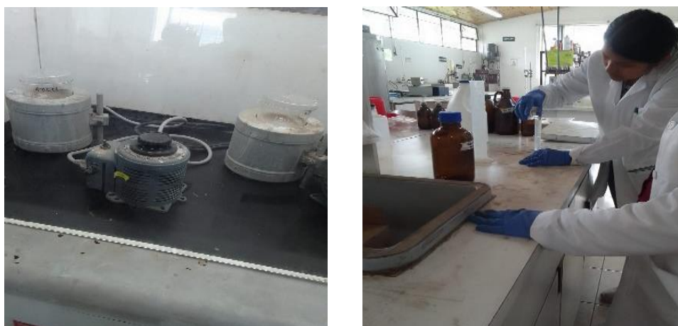
Figura N° 15. Digestión de las muestras para determinar fibra cruda
