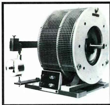
FIGURA 1.15: FRENO POR CORRIENTES DE FOUCAULT CON DINAMÓMETRO.
