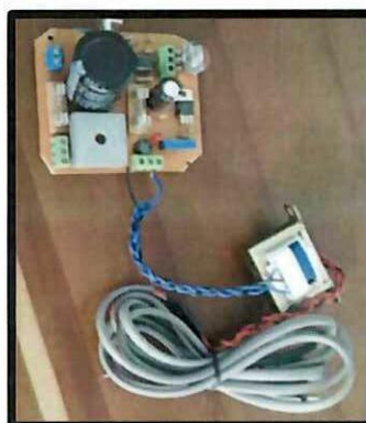
FIGURA 3.8: TARJETA ELECTRÓNICA DE CONTROL Y POTENCIA
