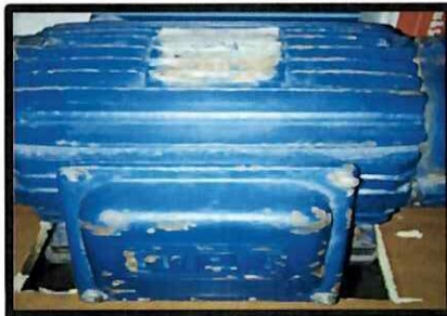
FIGURA 3.3: Motor Weg (M2),3HP (Electrodinámometro).
