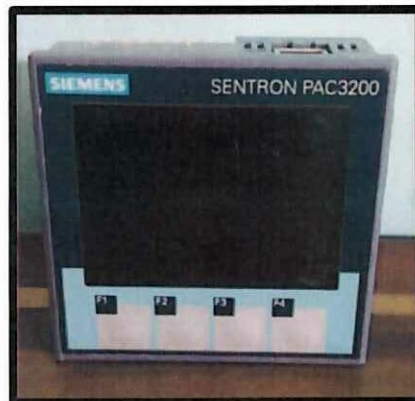
FIGURA 3.10: MULTIMEDIDOR SENTRON PAC 3200
