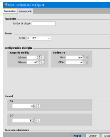
Figura 5.15. Configuración de los valores establecidos para el comparador analógico del Sistema de Riego
