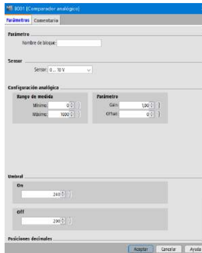
Figura 5.12. Configuración de los valores establecidos para el comparador analógico
