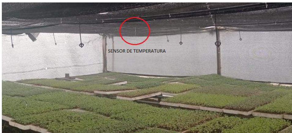
Figura 5.7. Ubicación del Sensor de temperatura Tipo K en el Invernadero
