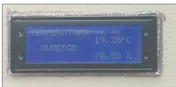
Figura 5.32. Datos de temperatura y humedad en la pantalla LCD
