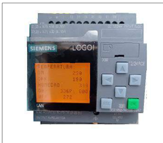
Figura 4.4. LOGO 12/24RCE SIEMENS 12/24VDC (4DI / 4DO) Tipo relé
