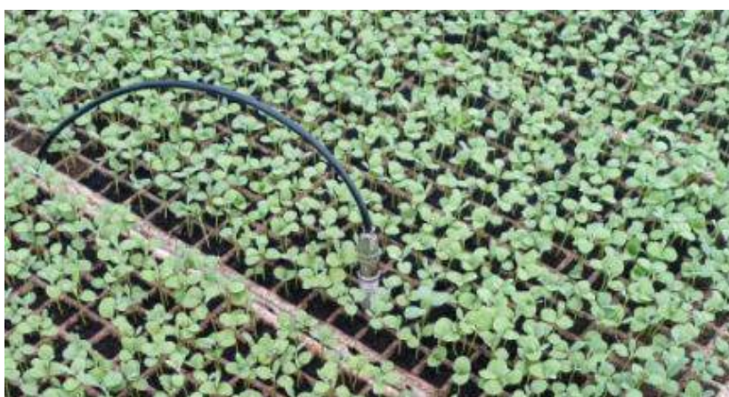
Figura 5.3. Ubicación del Sensor de Humedad SHT10 en las bandejas del Invernadero
