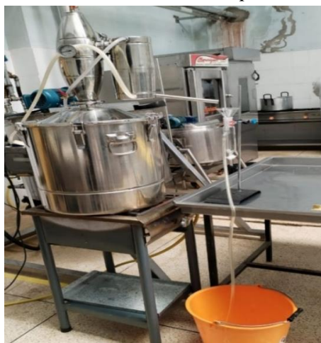
Figura 10. Extracción del aceite por arrastre de vapor
