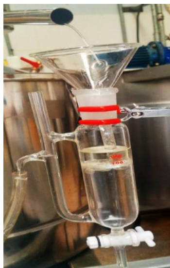
Figura 12. Separación del aceite e hidrolato
