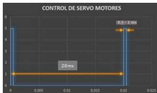
Figura 27. Control de servomotores
