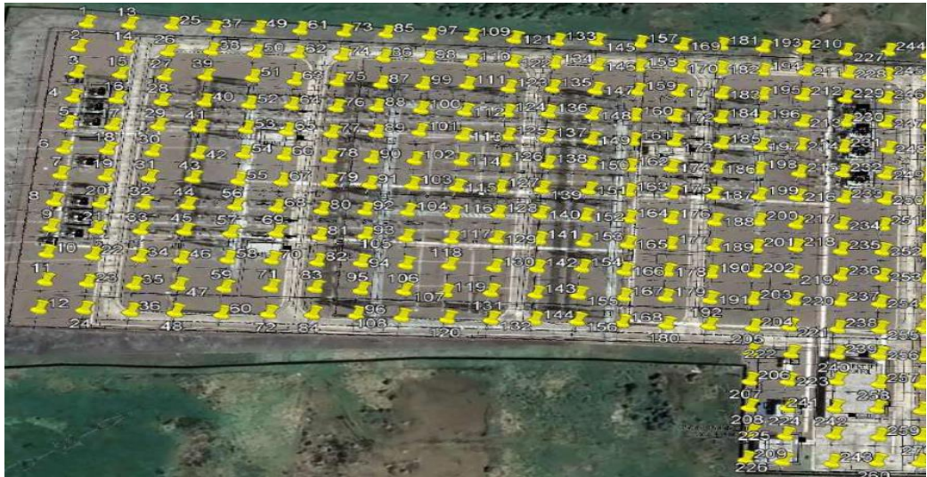
Figura 19. Puntos de medición, primera etapa – patio de 500 kV Subestación Tisaleo. Fuente: Autor
