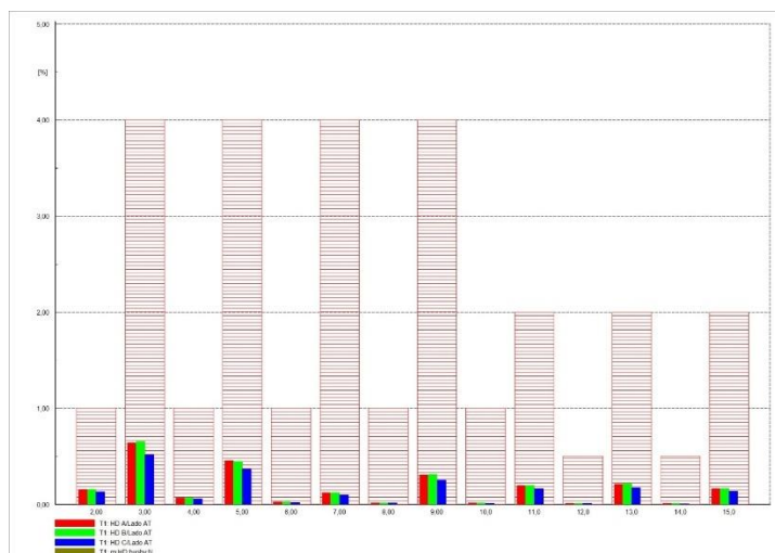
Figura 29. Armónicos individuales en el transformador trifásico.
