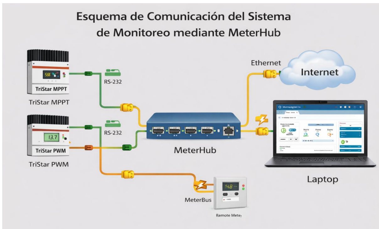
Figura 35. Esquema de comunicación del sistema de monitoreo mediante MeterHub.
