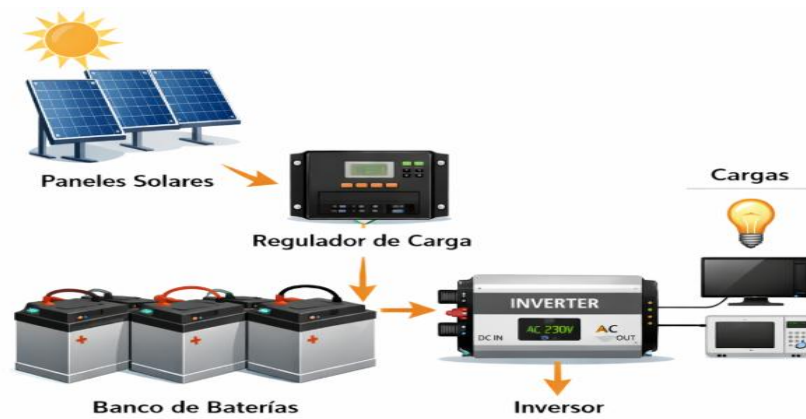
Figura 1. Sistemas Fotovoltaicos Aislados.
