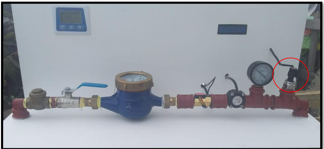
Fig. 4.2: Conexión del sensor de presión
