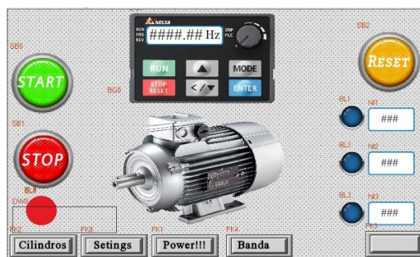
Figura 27. Pantalla principal del HMI – Control operativo y monitoreo del proceso
