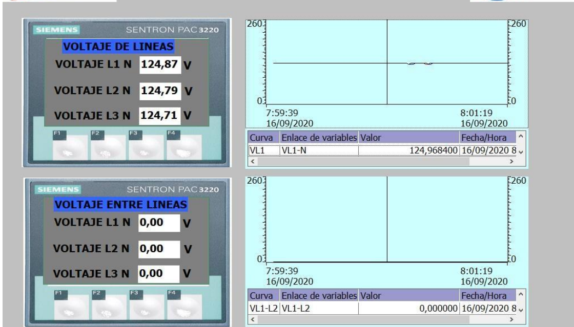
Figura 58. Datos en tiempo real de los niveles de tensión en Wincc.
