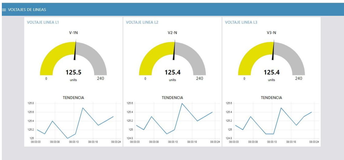
Figura 59. Datos en tiempo real de los niveles de tensión en la plataforma virtual. Fuente: Autoría propia
