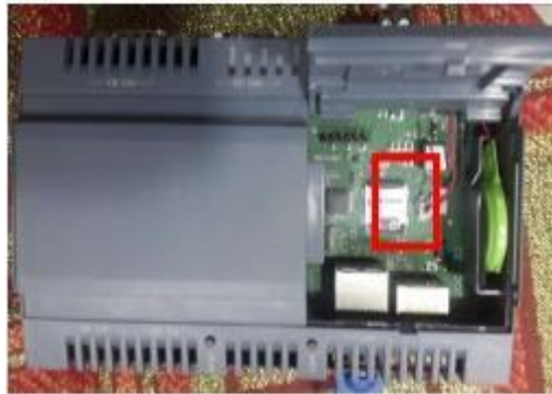
Figura 38. Colocación de SD en IoT2040.
