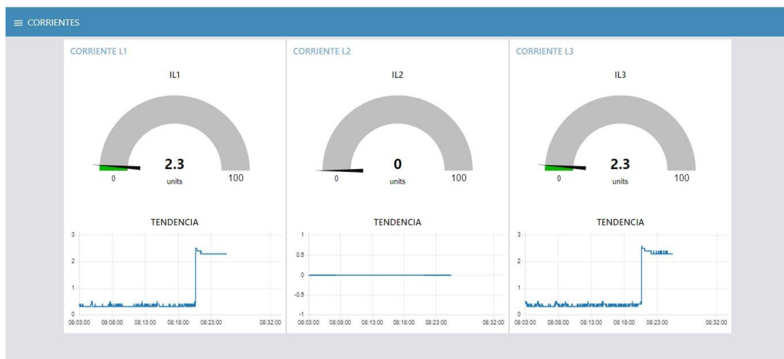
Figura 64. Datos en tiempo real de las corrientes en la plataforma virtual. Fuente: Autoría Propia
