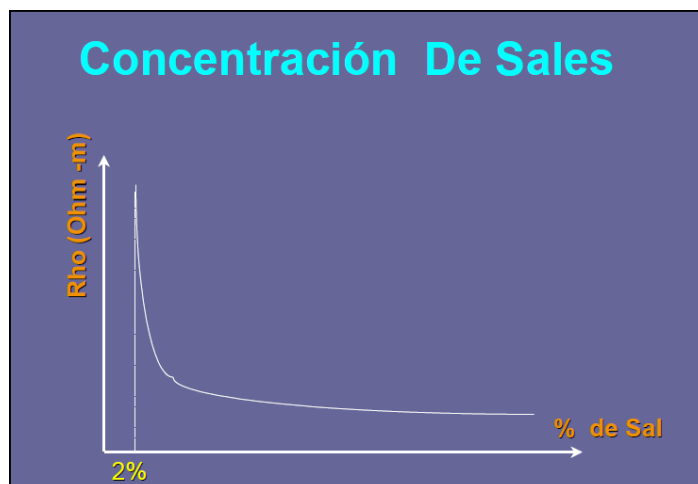
FIGURA # 38 VARIACIÓN DE LA RESISTIVIDAD DEL TERRENO EN FUNCIÓN DEL % DE SAL
