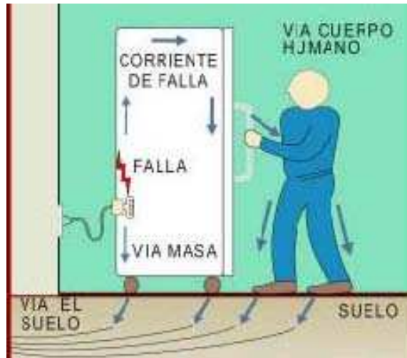
FIGURA # 3 CORRIENTE DE FALLA RETORNANDO A LA FUENTE
