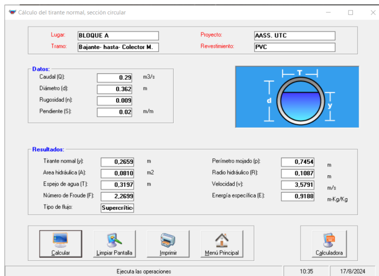
Figura 13. Cálculo de la capacidad Hidráulica mediante H-Canales.
