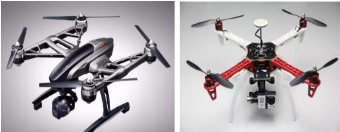
Figura 4: Drones multirotor o multicóptero Fuente: (Ruipérez, 2015)
