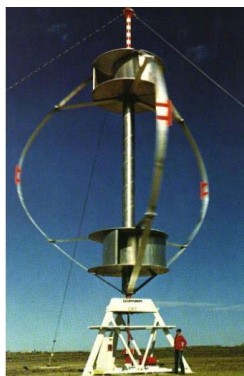
Figura 6. Aerogenerador de eje vertical [14].
