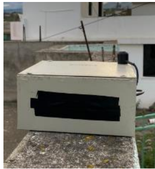
Figura 20. Piranómetro colocado en la comunidad de Alpamalag.
