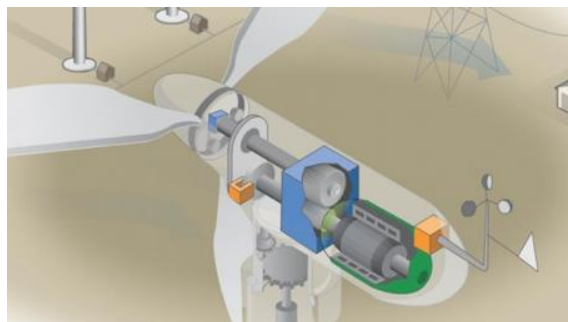
Figura 4. Partes internas del generador eólicos [13].
