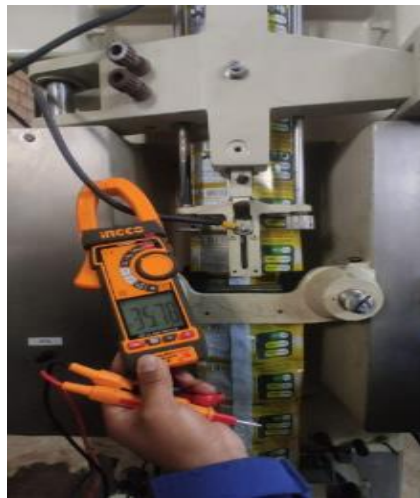
Figura 5.57. Prueba de consumo en amperios de la prensa vertical.
