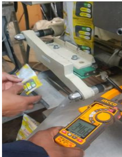
Figura 5.55. Prueba de consumo en amperios de la prensa horizontal.
