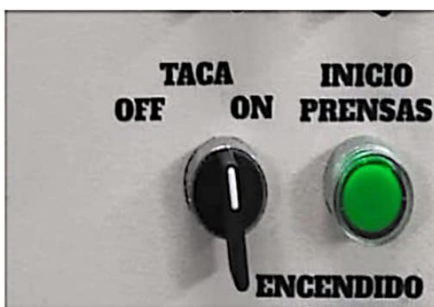
Figura 9. Selectores del modo de trabajo con el sensor de TACA e inicio de prensas.
