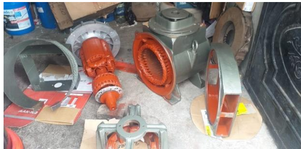
Figura X.10 Barnizado de los elementos del generador
