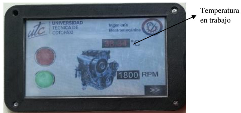
Figura 5.11 Temperatura con motor en funcionamiento.
