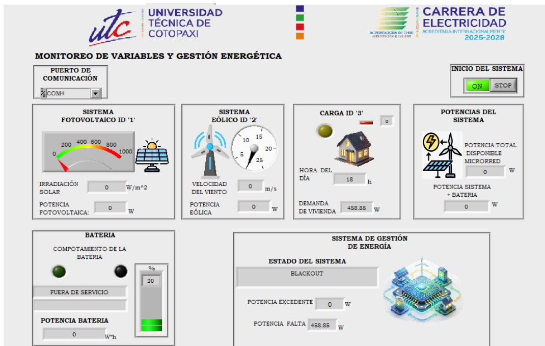
Figura. 64. Escenario de operación falla de suministro (Blackout).
