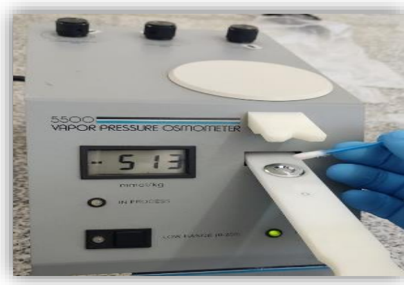
Figura 35 Verificación de la limpieza del termopar
