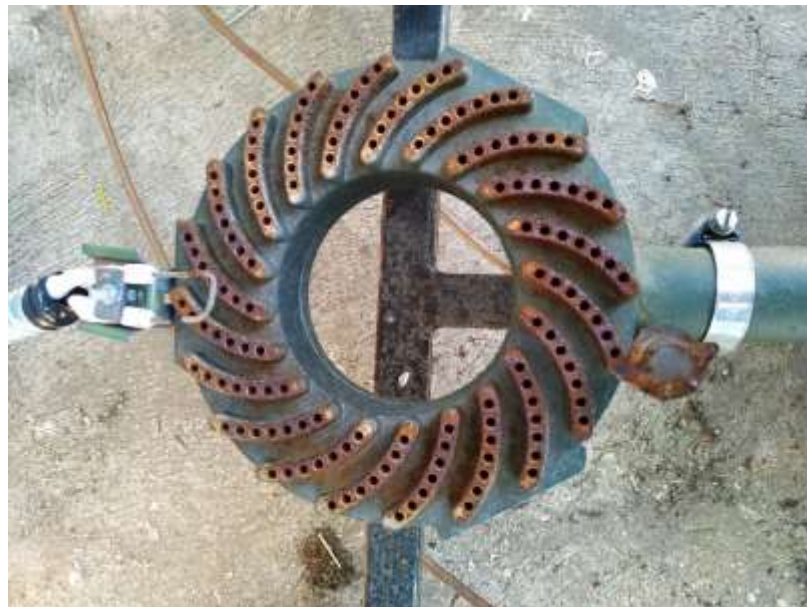
Anexos XV Quemador con encendido por arco eléctrico con llama piloto
