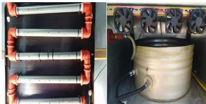
Figura 4.9 Torre de refrigeración de tiro mecánico
