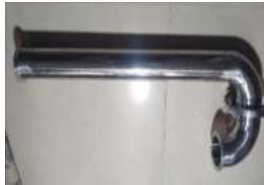
Figura 4.6 Tubería para vapor de acero inoxidable 304
