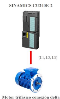
Figura 2. Conexión del variador CU240E-2 al motor
