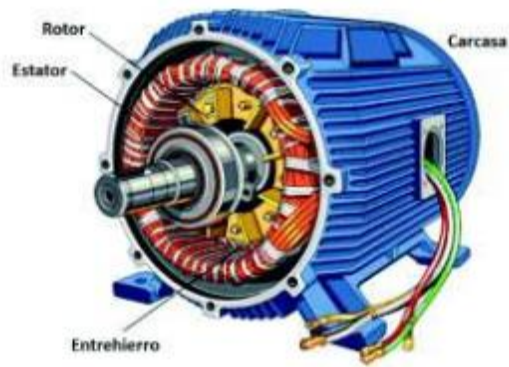
Figura 1. Componentes del motor de inducción
