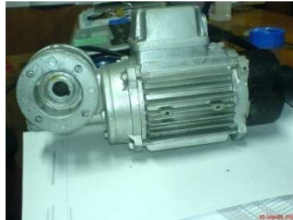
FIGURA 3.5. MOTO-REDUCTOR SELECCIONADO PARA ACCIONAR LA BANDA
