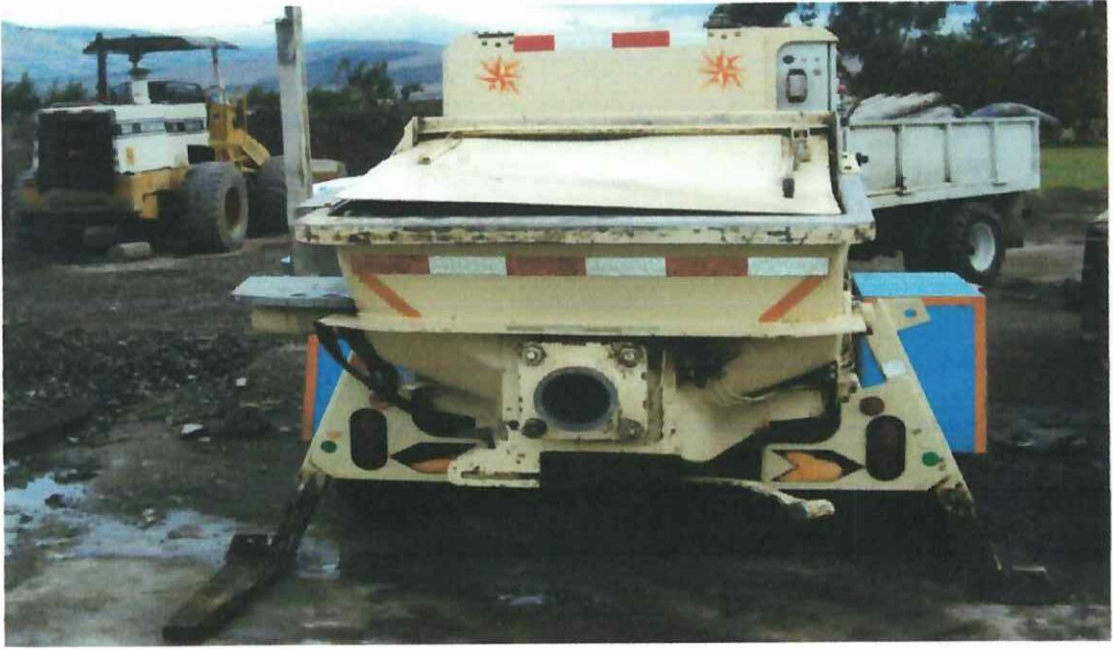
Fotografía N°10 Bomba de Concreto
