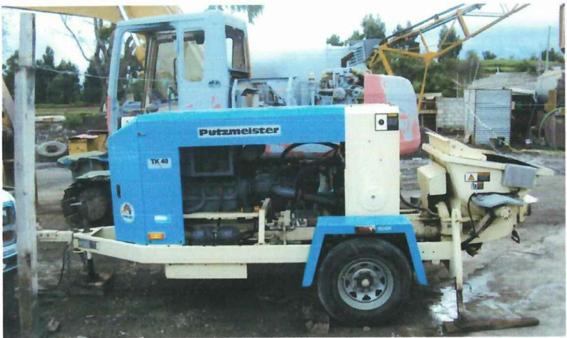
Fotografía N°11 Bomba de Concreto
