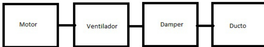
Figura 5.1 Componentes iniciales del banco de pruebas motor – ventilador centrífugo
