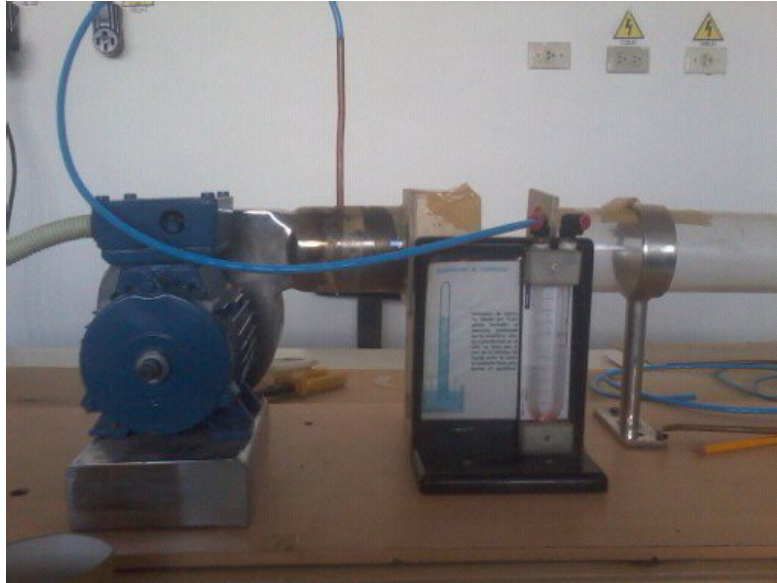
Figura 3.5 Obtención de presión estática Fuente: Laboratorio de Máquinas Eléctricas
