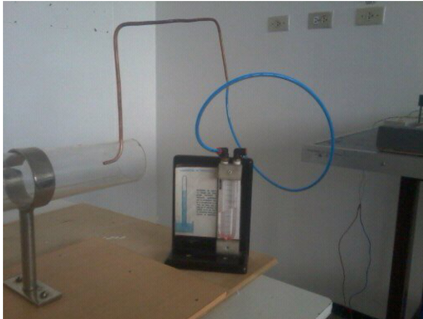
Figura 3.4 Obtención de presión dinámica a la salida del sistema Fuente: Laboratorio de Máquinas Eléctricas
