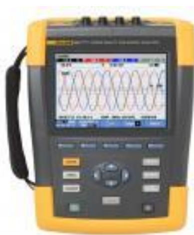
Figura 8. Analizador de energía
