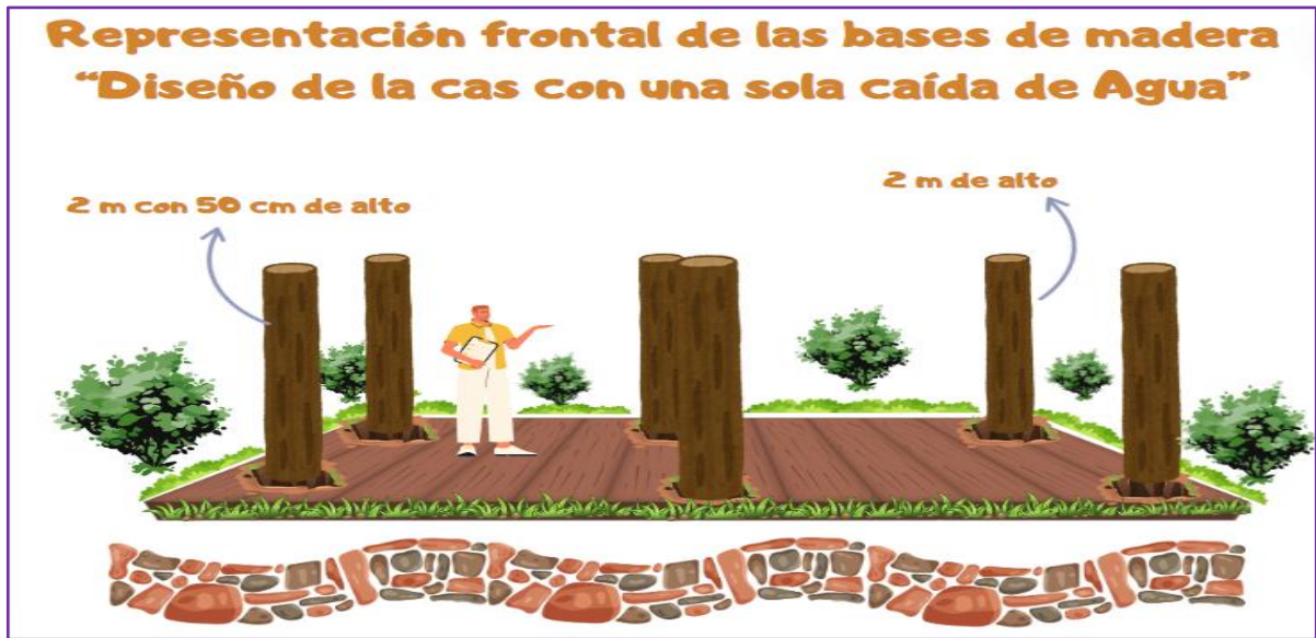
Ilustración 11. Colocación de Columnas
