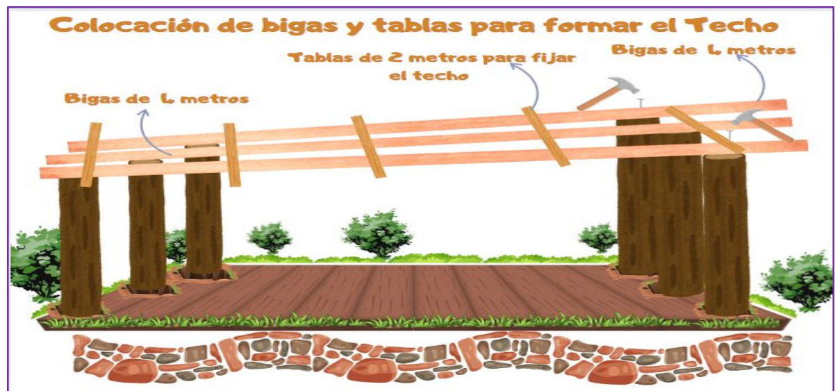
Ilustración 12. Colocación de Bigas y Tablas
