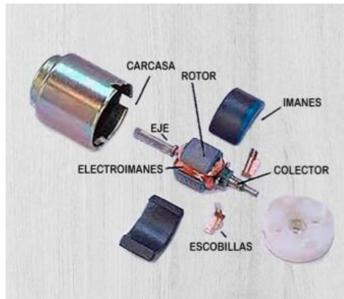
Figura 3.8. Componentes de motores DC [15]
