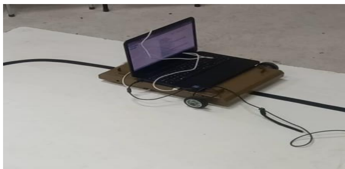
Figura 5.29. AGV probado en una ruta realizada en el laboratorio de robótica
