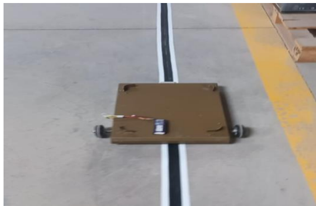
Figura 5.30. AGV siguiendo una ruta trazada en suelo industrial
