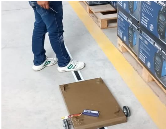
Figura 5.32. AGV deteniéndose al detectar un obstáculo
