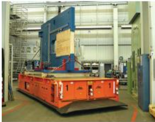
Figura 3.5. AGV de servicio pesado [9]
