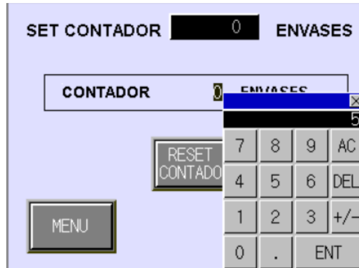
Figura 3. Ingreso de set point en el contador.
