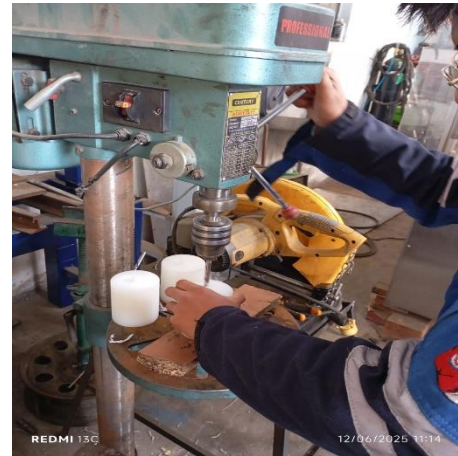
Figura A. 13 Construcción de aumentos para los cabezales de tapado
