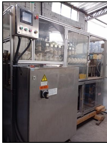
Figura 3-2. Tapadora de botellas a presión
