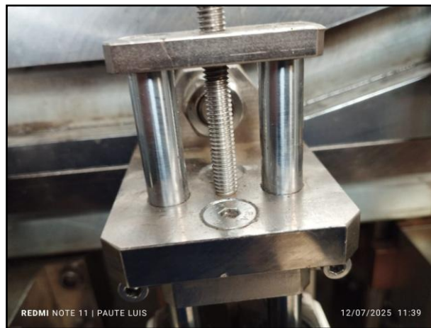
Figura 4-5. Avellanado de rosca para aumento de longitud en el cabezal de tapado.
