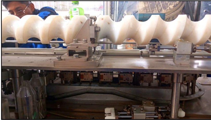
Figura 4-6. Altura inadecuada del tornillo sin fin.
