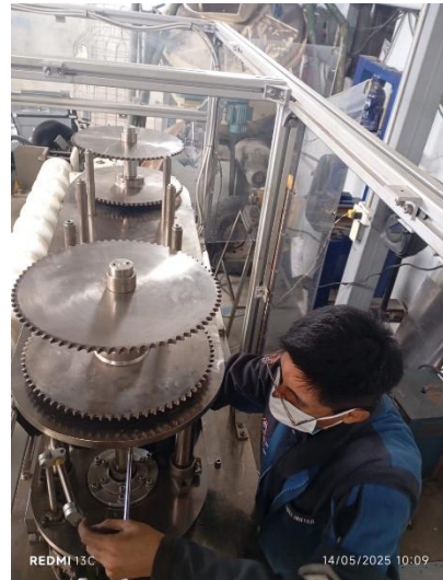
Figura A. 9 Armado se sistema de tapado
