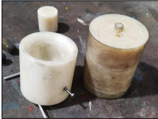
Figura 4-4. Piezas de alzado y relleno del mandril de tapado.
