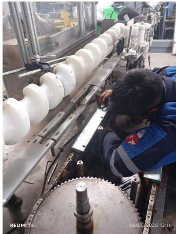
Figura A. 6 Ajuste de altura de tornillo sin
