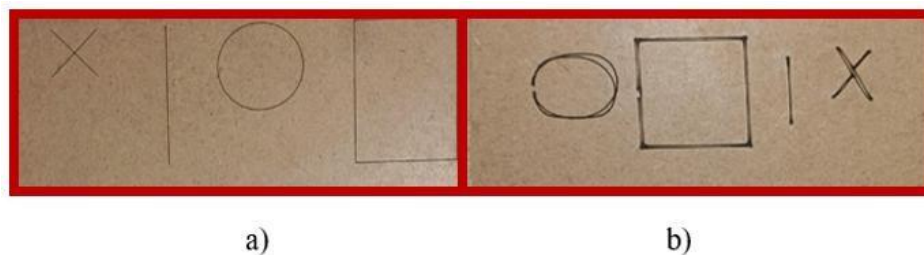
Figura 5.18. a) Ruteado láser entre Xtool vs b) CNC doble cara
