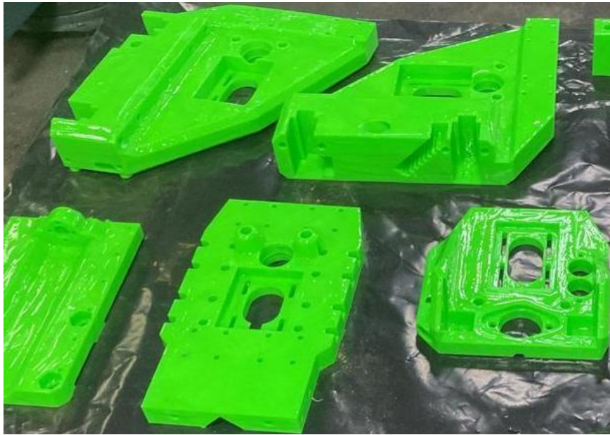
Figura 4.15. Impresión en PLA del diseño mecánico
