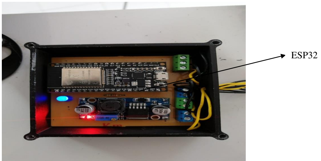
Figura 4.34 Conexiones de los elementos con el ESP32.
