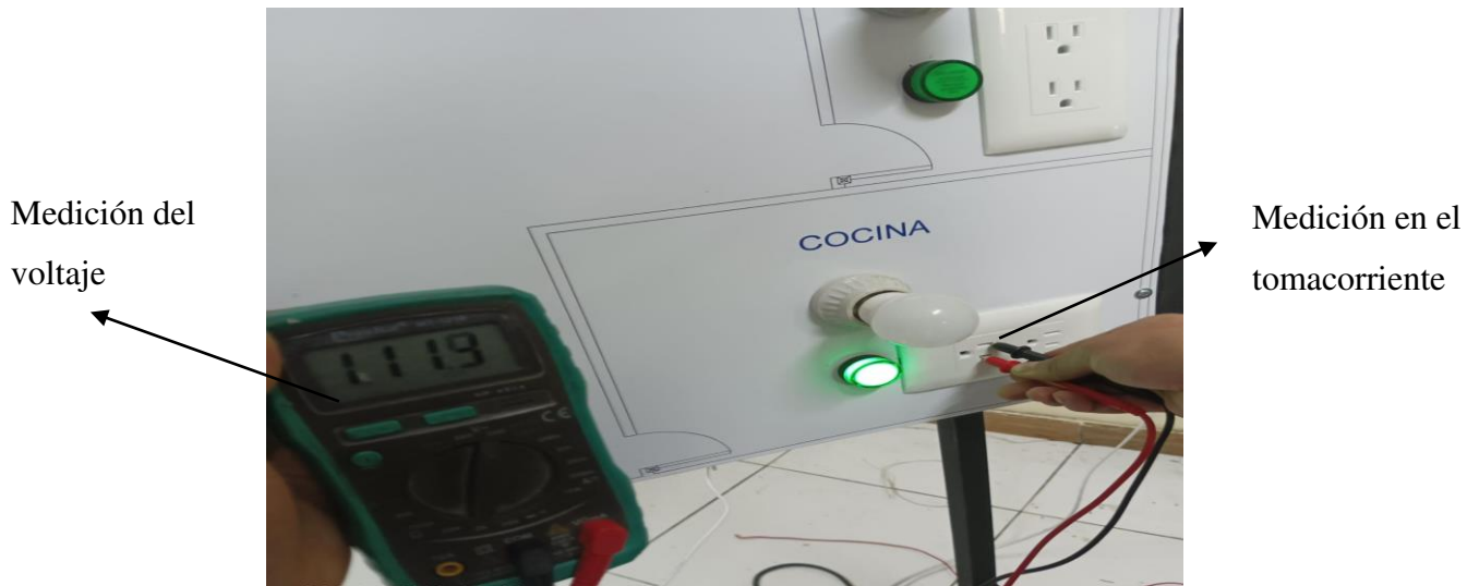
Figura 4.14 Comprobación del voltaje obtenido en el departamento.
