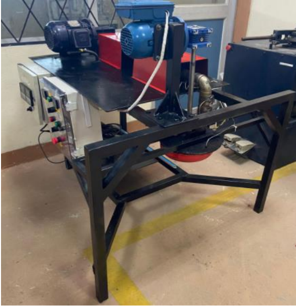
a) Fibradora conexión motorreductor
