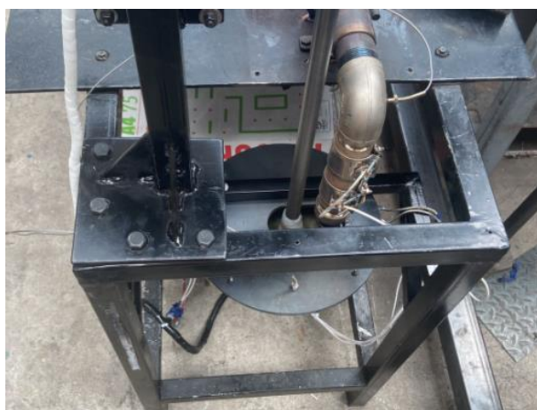
Figura 5. 14 Conexión entre la máquina extrusora y la fibradora.
