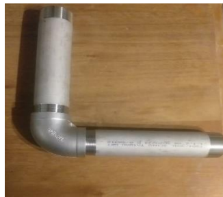
Figura 5. 3 Conexión de tubos y codo
