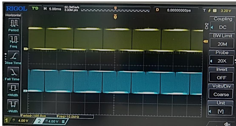
Figura 25: Señales amplificadas por el IR2113.
