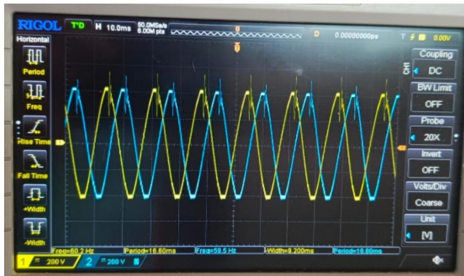
Figura 35: Señales senoidales en dos fases (A y B).
