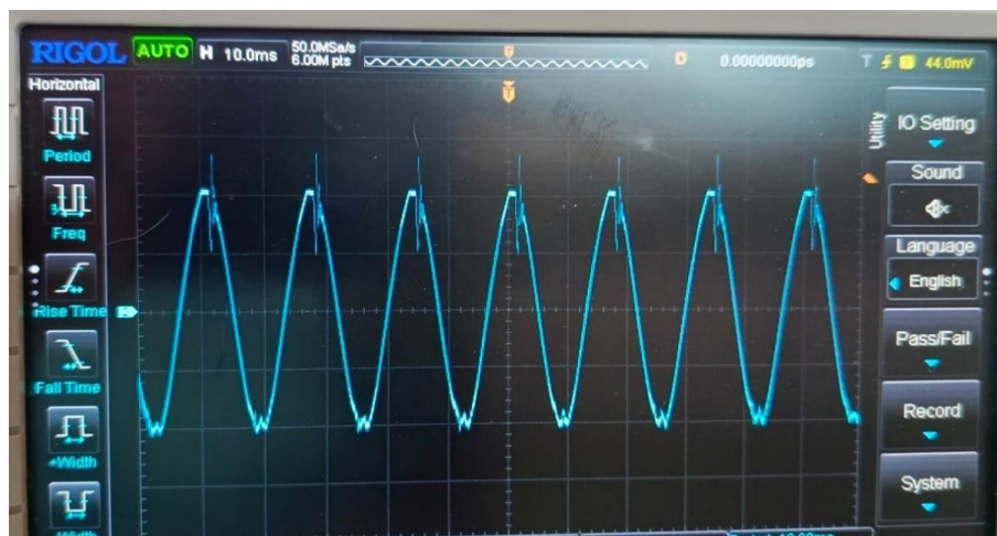
Figura 32: Señal alterna sin filtrar por fase (fase A).
