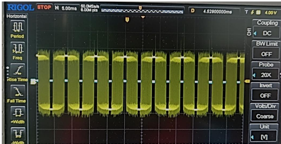
Figura 27: Señal portadora a 25kHz.
