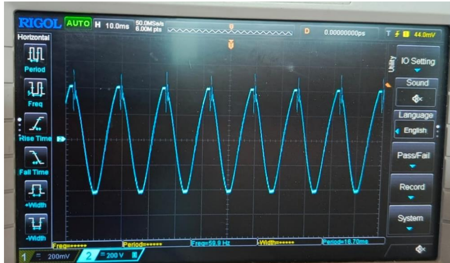
Figura 34: Señal alterna filtrada por fase (fase A).
