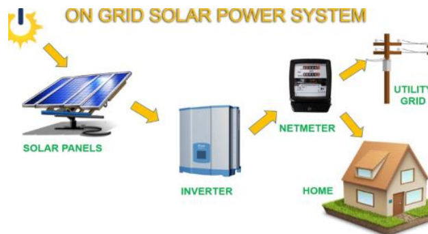
Figura 8: Inversor de conexión a la red
