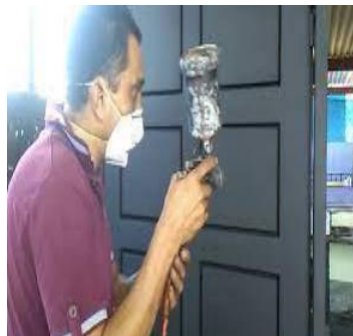
Figura 3.19. Proceso pintado electrostático
