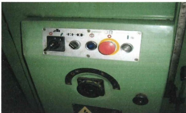
Figura 34. Panel de encendido de la fresadora X615A
